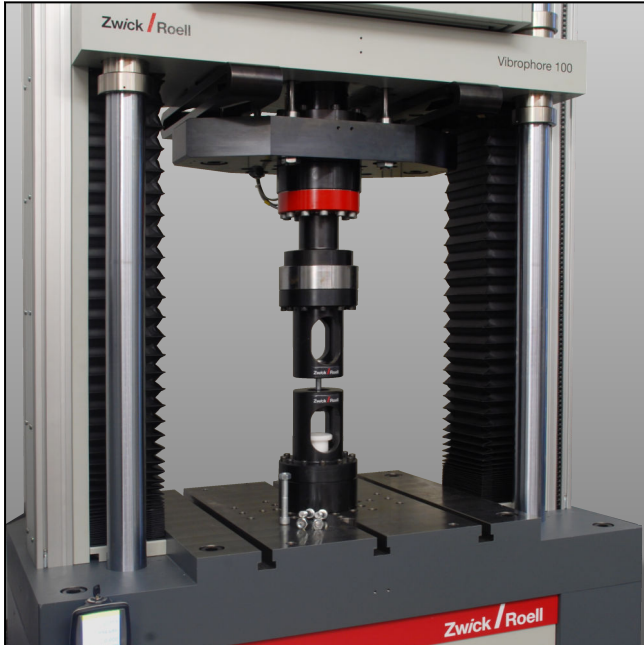
Abbildung: Vibrophore-Probenhalter für Schrauben
