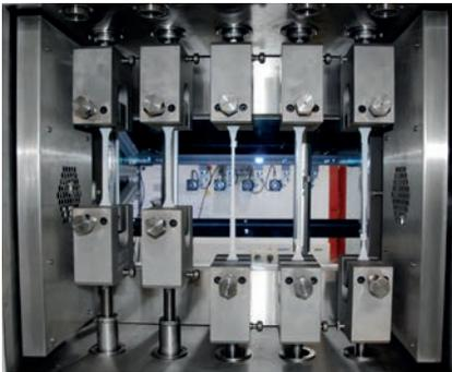
Bild 1: Zeitstandversuch bei Zugbeanspruchung, ISO 899-1, ASTM D 2990
