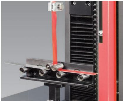
Bild 1: 90° Abzugsversuch zur Messung des Schälwiderstands
