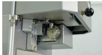
Bild 3: Abschneidevorrichtung mit Düsenverschluss
