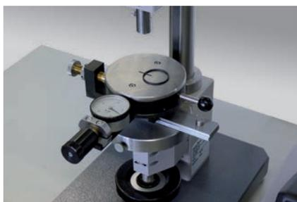
Bild 2: Härteprüfung an O-Ringen
