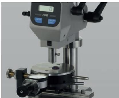
Bild 6: IRHD Härtemessung an einem O-Ring
