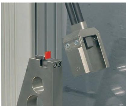
Bild 4: Einrichtung für Dynstat Schlagbiegeversuch
