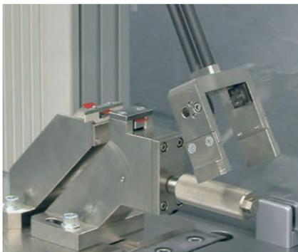
Bild 3: Einrichtung für Schlagzug nach ISO-Verfahren A
