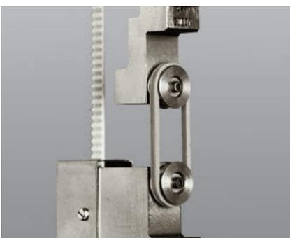
Bild 4: Zugversuch an Ringproben nach ISO 37
