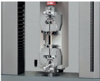
Bild 4: Mechanischer Langwegaufnehmer
