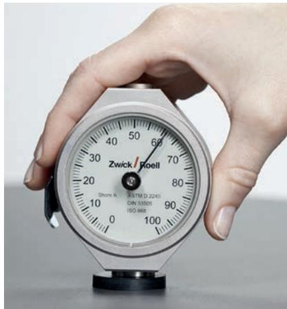
Bild 2: Analoges Shore-Härteprüfgerät
