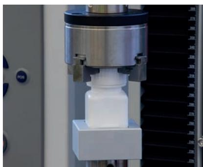
Bild 7: Funktionsprüfung von Sicherheits-Schraubverschlüssen
