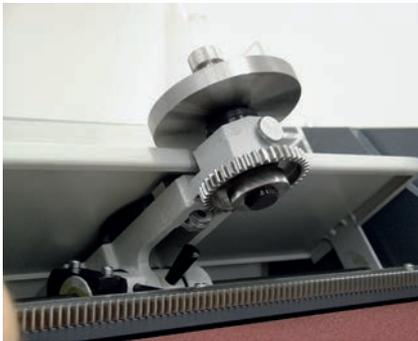
Bild 1: Abriebwiderstand, ISO 4649
