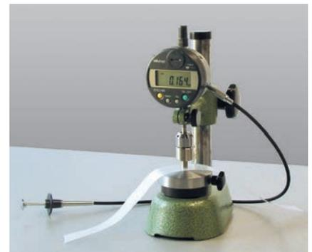
Bild 3: Dickenmessgerät mit konstanter Messkraft (DM-THICKGA.000 + DM-PLASTOFOI.S00)
