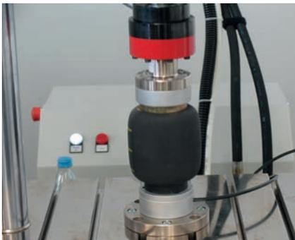
Bild 3: Ermüdungsprüfung von Dämpfern...
