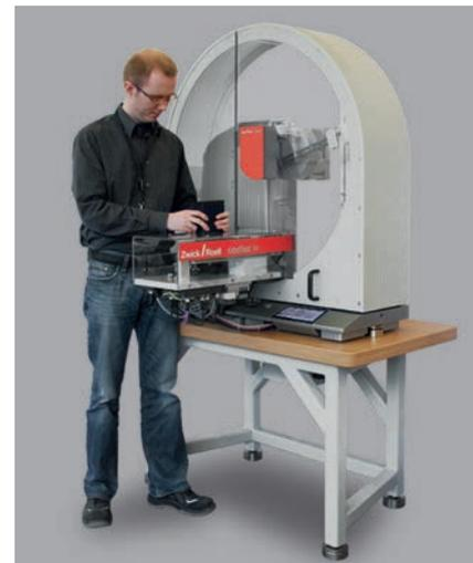
Bild 3: Probenzuführung für Charpy und Izod 'roboTest H'
