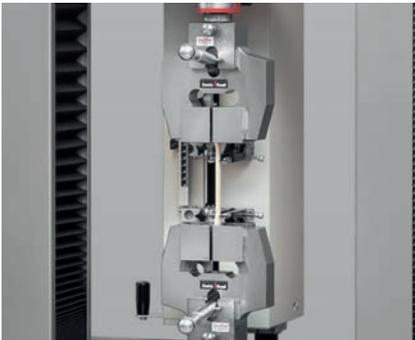
Bild 2: Zugversuch, z.B. nach ASTM D 638 (Qualitätsüberwachung)
