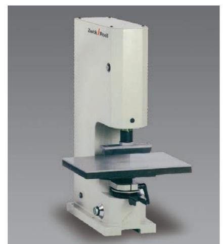
Bild 4: Pneumatik-Schneidpresse 7108
