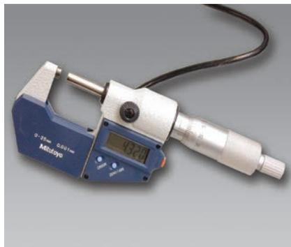
Bild 2: Bügelmessschraube mit Ratsche
