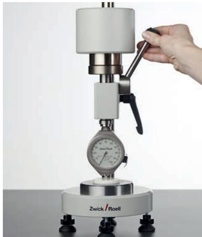
Bild 3: Analoges Shore A Härteprüfgerät mit Prüfstander
