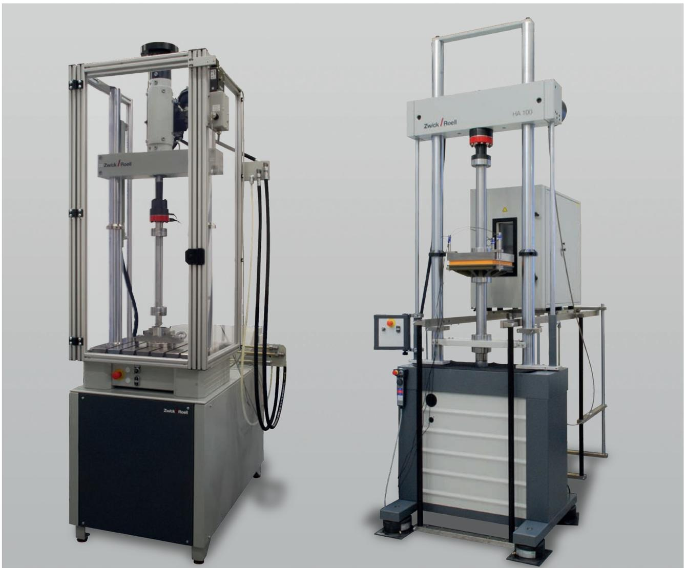
Bild 1: Servohydraulische Prüfmaschinen für schnelle zyklische Beanspruchung
