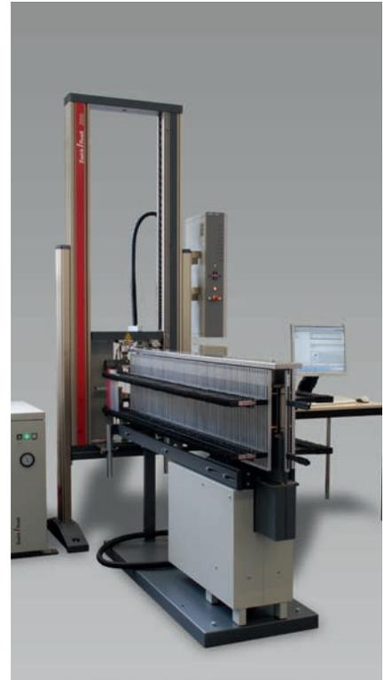
Bild 3: 'roboTest F' zur automatischen Probenzuführung von Folien
