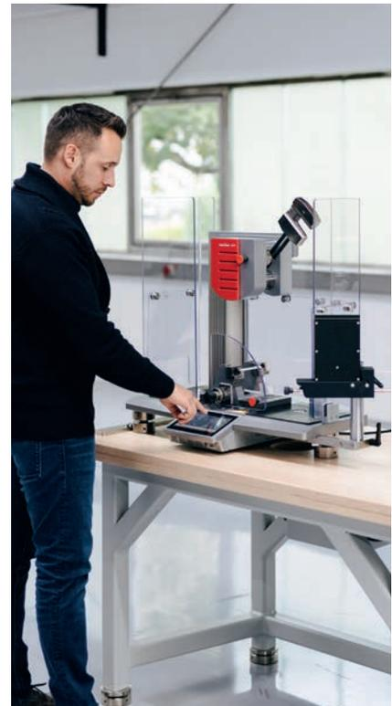
Bild 2: Pendelschlagwerk HIT5P
