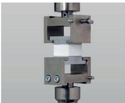
Bild 4: Zugversuch senkrecht zur Plattenebene nach EN 1607
