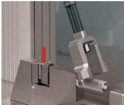
Bild 1: Konventionelle Schlagprüfungen: Links Charpy, rechts Izod
