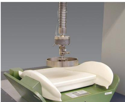
Bild 3: Eindruckhärte an Formschäumen (DIN 53579-1)
