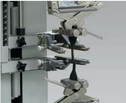
Bild 1: Zugversuch nach ISO 37
