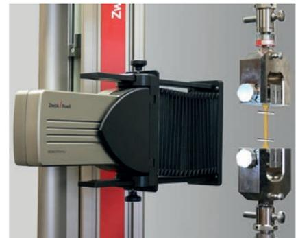
Bild 5: videoXtens HP für optische Längen- und Querdehnungsmessung
