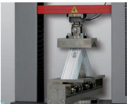
Bild 3: Eckfestigkeit eines Fensterprofils
