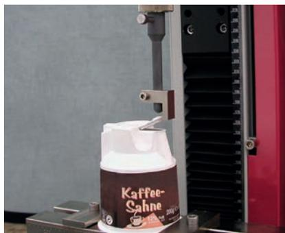
Bild 5: Bestimmung von Betätigungs Kräften
