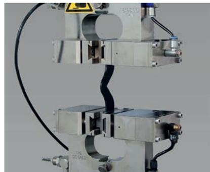
Bild 3: Weiterreiversuch an einer Winkelprobe nach ISO 34-1
