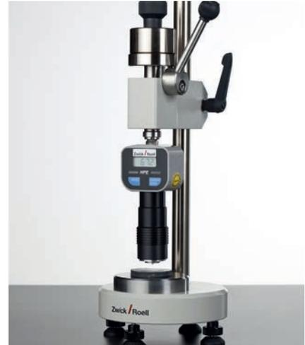
Bild 5: Digitales Shore Härteprüfgerät mit Prüfstander
