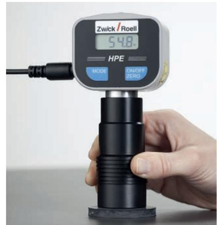
Bild 4: Digitales Shore-Härteprüfgerät mit integrierter Elektronikheit
