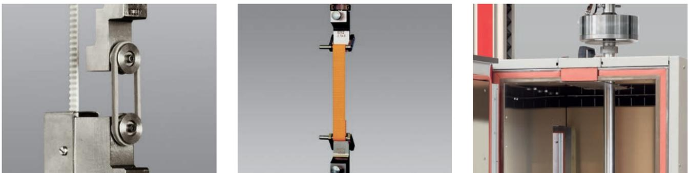
Bild 3: Schraub-Probenhalter, parallel klemmend für dünne und feste Werkstoffe in verschiedenen Zugkraftbereichen.
