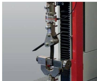
Bild 5: Rollenschälversuch nach ISO 4578
