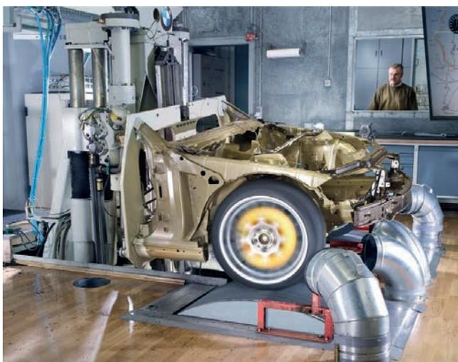
Bild 1: Mehrachsiger Prüfstand für Nachfahrversuche (Bild: © IABG)
