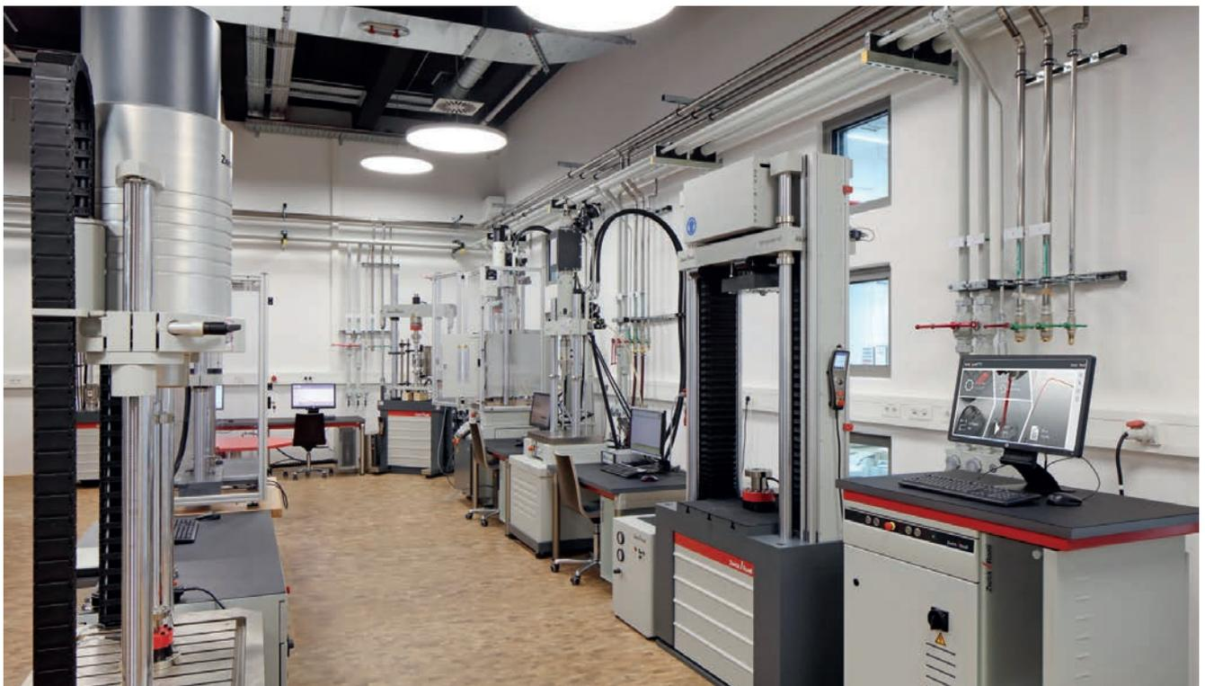
Bild 1: Ein Teil der dynamischen Prüfmaschinen im ZwickRoell Labor für Material- und Bauteilprüfung
