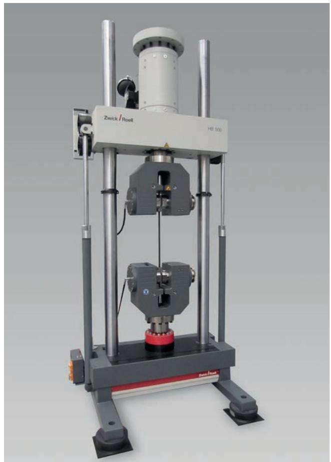
Bild 2: Dauerschwingversuch an Litzen gemäß ISO 15630-3
