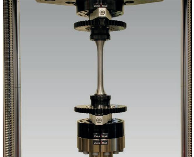
Bild 2: Rundproben mit Schnelleinspannvorrichtung
