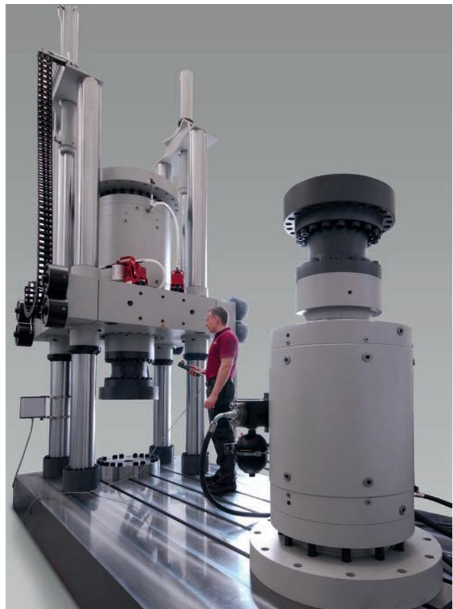
Bild 3: Servohydraulisches Prüfportal zur Prüfung von Flugzeugkomponenten
