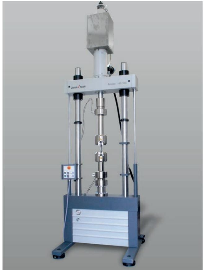
Bild 2: Servohydraulische Prüfmaschine HBT 100 mit integriertem Torsionsantrieb
