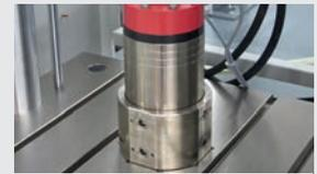
Ausrichteinheit 25 kN
