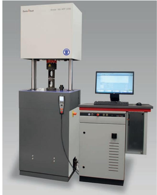
Bild 2: Modernisierung eines Hochfrequenzpulsators mit testControl II
