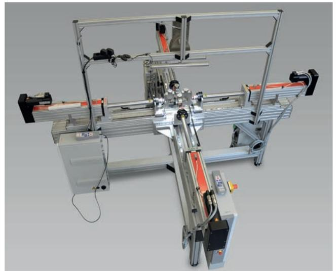
Bild 2: Biaxiale Prüfmaschine bestehend aus 4 Servo-Prüfzylindern
