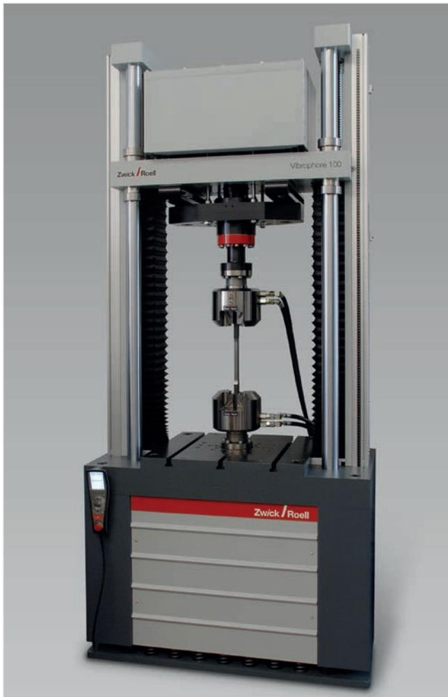
Bild 1: Hochfrequenzpulsator Vibrophore 100 mit hydraulischem Keil-Probenhalter
