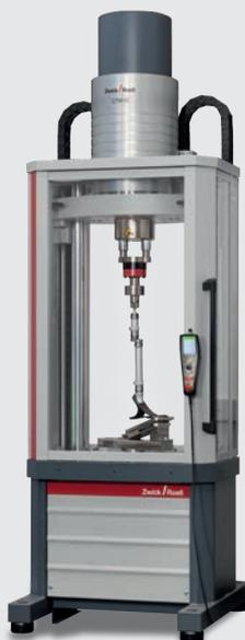
Elektrodynamische Prüfmaschine LTM
