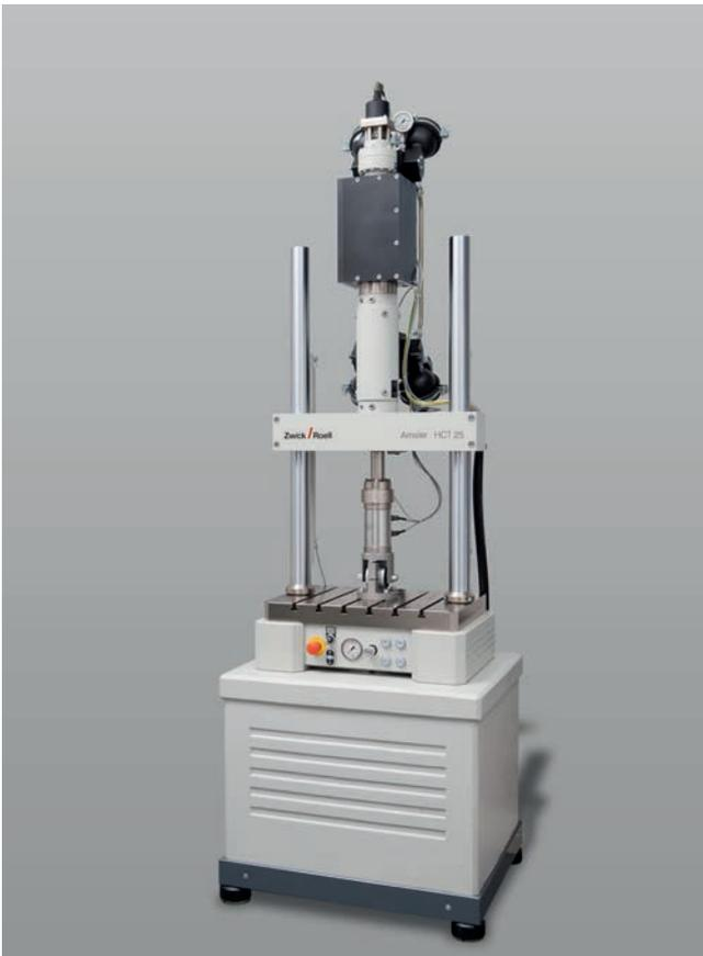
Bild 1: Servohydraulische Prüfmaschine HCT 25 mit integriertem Torsionsantrieb
