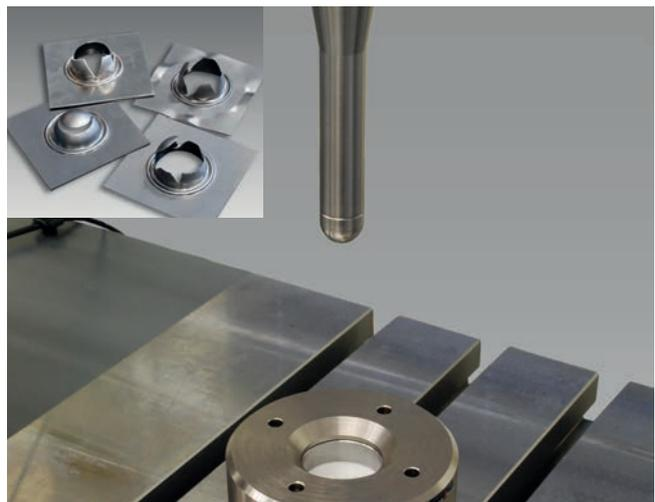
Bild 2: Prüfvorrichtung für Durchstoβversuche
