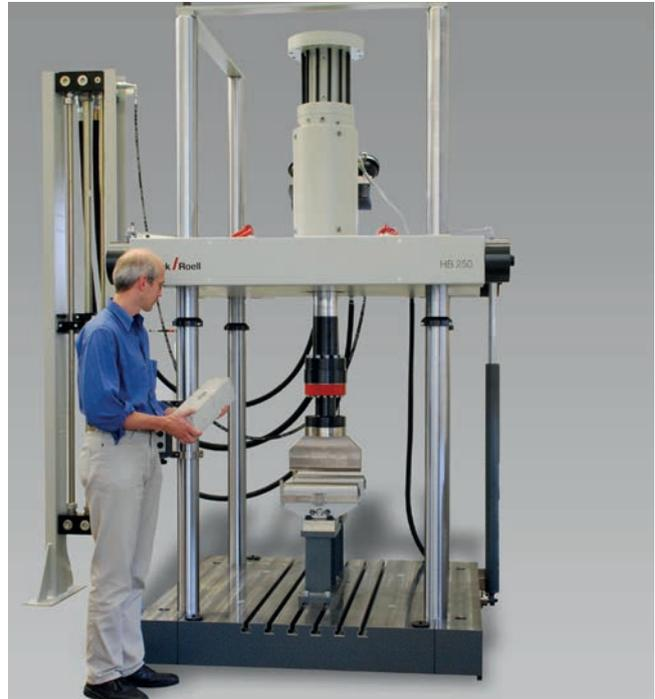
Bild 2: Viersäulige HB250 zur Werkstoff- und Bauteilprüfung
