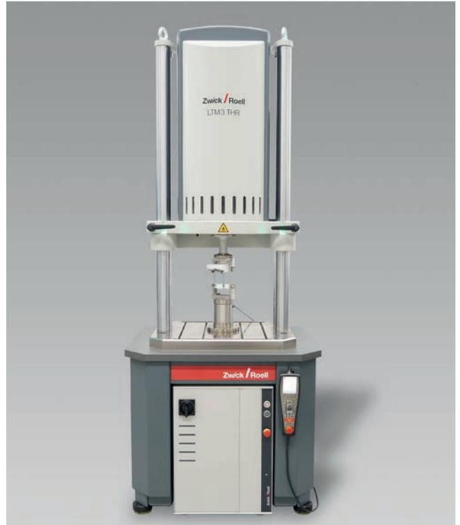
Bild 1: Linearprüfsystem LTM 3 mit Torsionsantrieb
