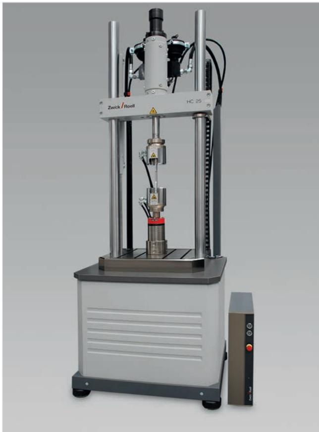
Bild 1: Servohydraulische Prüfmaschine HC 25 mit Betonsockel
