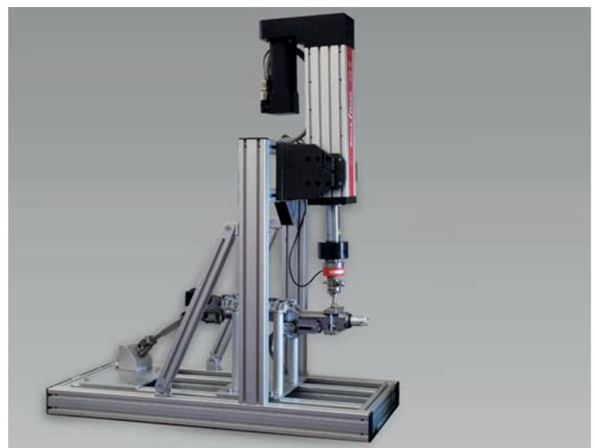
Bild 3: Elektromechanischer Servo-Prüfzylinder für Ermüdungsversuche an einem Lenkgestänge
