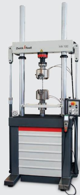
Servohydraulische Prüfmaschine HA
