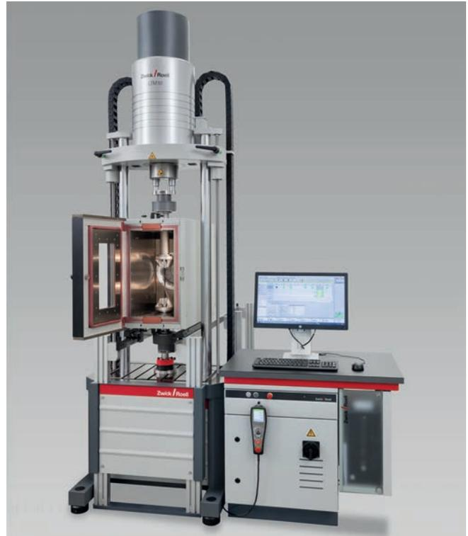
Bild 2: Linearprüfsystem LTM 10 mit Temperierkammer
